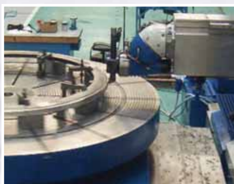
Lavorazione di tornitura su alesatrice Turning on milling machine
