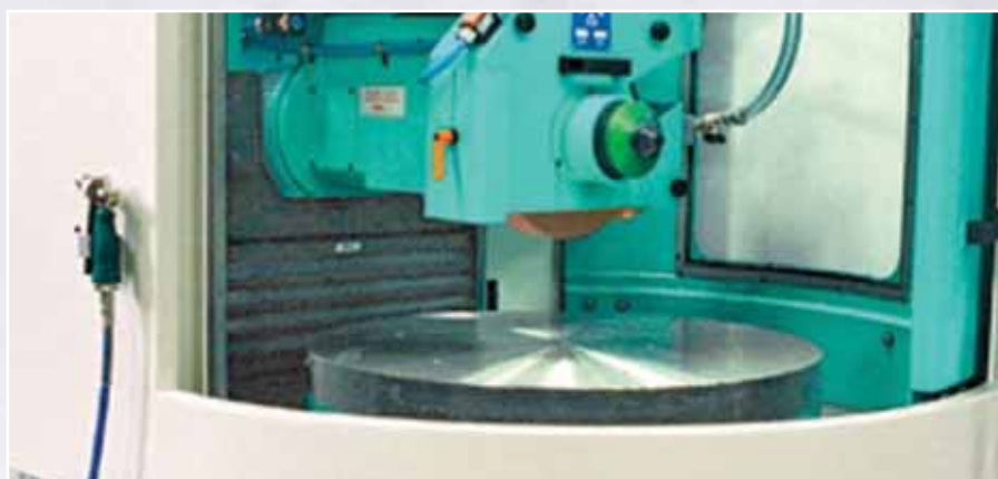
Tavola CNC \varnothing 1000 - 100 rpm applicata su macchina di rettifica CNC rotary table \varnothing 1000 - 100 rpm applied on grinding machine
